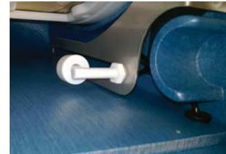
Verwijder de rubber stop van de vlotter uit de behuizing en trek de stekker aansluiting los. Duw de stekker aansluiting door de rubber dop zodat deze vrij is.
