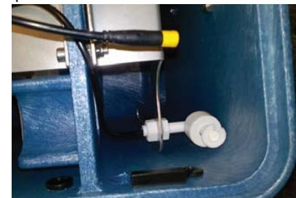
Steek de stekker aansluiting door het gat naar buiten en steek deze vervolgens door de rubber dop. Het gat van de rubber dop kan eventueel wat worden vergroot door er een klein sneetje met een scherp mes in te maken. Steek de rubber dop in het middelste gat.
