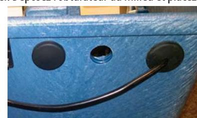
À présent, tirez le branchement de fiche du flotteur en premier à travers l'étrier dans la chambre d'admission. Lors de cette opération, veillez à tourner le flotteur de 180 degrés par rapport à l'installation gravitaire ! Ensuite, posez l'écrou sur la fiche et vissez-le sur le flotteur.
