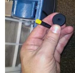
Entfernen Sie jetzt den Schwimmer aus der Trommelkammer in dem Sie Kabel und Mutter durch den Bügel ziehen. Platzieren Sie den mittleren Blindstopfen in der linken Öffnung.
