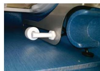
Entfernen Sie den Gummistopfen des Schwimmers aus dem Gehäuse und lösen Sie den Stecker. Schieben Sie den Stecker durch das Gummi so dass dieser frei wird.
