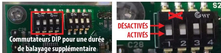
De plus, il est aussi possible d'utiliser une combinaison de commutateurs DIP pour que les durées en question s'additionnent. Exemple : commutateurs 1 et 2 sur "ACTIVÉS" et les autres sur "DÉSACTIVÉS" débouche sur un allongement du temps de balayage de 6 secondes, etc. Toute combinaison de commutateurs est possible.
