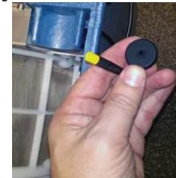
Haal nu de vlotter uit de trommelkamer door de kabel en de moer via de beugel te steken. Verwijder de blinde stop uit het midden en plaats deze in het linkse gat.
