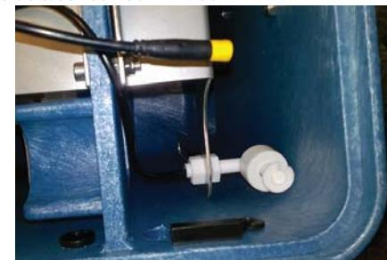
Führen Sie den Stecker durch die Durchführung nach außen und montieren Sie darauf die Gummiabdichtung. Evtl. müssen Sie mittels eines Messerschnittes das Loch der Durchführung ein wenig vergrößern. Platzieren Sie nun die Gummiabdichtung in dem mittleren Loch.
