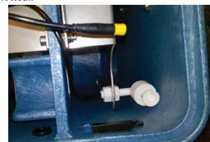
Tirez le branchement de fiche à travers le trou vers l'extérieur et tirez-le ensuite à travers le bouchon caoutchouc. Le trou du bouchon caoutchouc peut éventuellement être légèrement agrandi en pratiquant une incision avec un couteau affûté. Placez le bouchon caoutchouc dans le trou du milieu.
