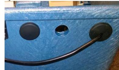
Führen Sie den Steckanschluss des Schwimmers zuerst durch den Bügel in der Einlasskammer. Achten Sie darauf, dass der Schwimmer im Gegensatz zu der Schwerkraftversion um 180° gedreht werden muss! Schieben Sie dann die Mutter über den Stecker und befestigen Sie diese an dem Schwimmer.
