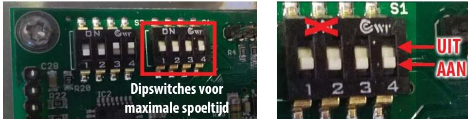
**Voorbeeld:** we gaan uit van de standaard maximale spoeltijd van 20 seconden. Dit betekent dat als de vlotter na 20 seconden spoelen niet terugkomt in de normale stand er een beveiligingsproces wordt geactiveerd. Dit bestaat uit de volgende stappen:
