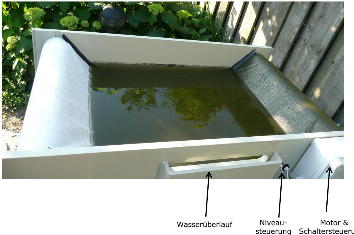
Im Falle einer Störung des Motors oder der Niveauregulierung wird das Wasser immer über den Überlauf zum Tank/Teich oder der Biokammer strömen, so dass der Wasserfluss kontinuierlich weiterläuft und der Filter nicht überläuft.
