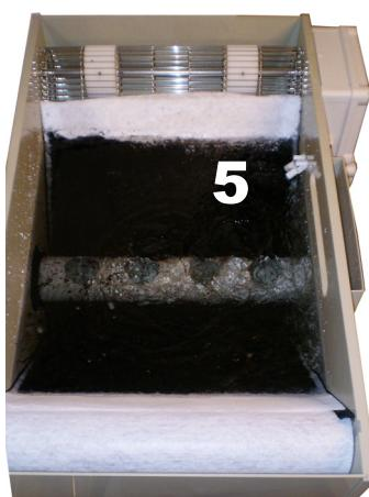
**Het vuile water zal het vlies verzadigen zodat het water zal stijgen totdat de niveauschakelaars worden bereikt (5).**
