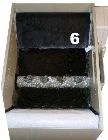
**De niveauschakelaars aktiveren de motor van de transportband en het vlies wordt vanaf nu automatisch verder getransporteerd (6).**
