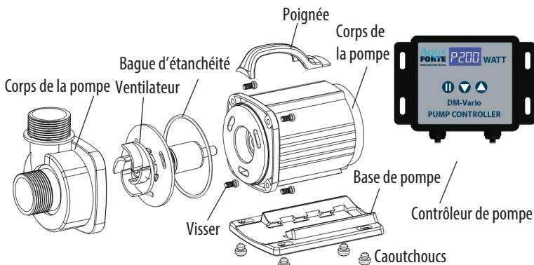
Retirez la fiche de la prise avant de procéder au nettoyage et à la maintenance de la pompe. Pour nettoyer la pompe, retirez la plaque arrière, le carter de pompe et le rotor. Utilisez une petite brosse et/ou de l'eau pour enlever toutes les saletés.
