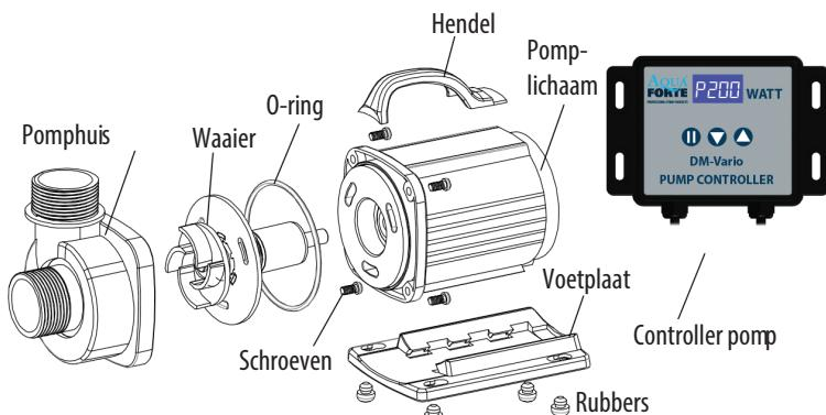
Haal de stekker uit het stopcontact voor het schoonmaken en onderhouden van de pomp. Voor het reinigen van de pomp, verwijder de achterplaat, pomphuis en de waaier. Gebruik een kleine borstel en/of water om al het vuil te verwijderen.
