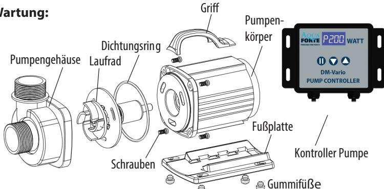
Trennen Sie vor jeder Wartung/Reinigung die Stromzufuhr. Entfernen Sie vor der Reinigung die Abdeckkappe, den Pumpenkörper und das Laufrad. Verwenden Sie eine kleine Bürste und/oder Wasser um den Schmutz zu entfernen.
